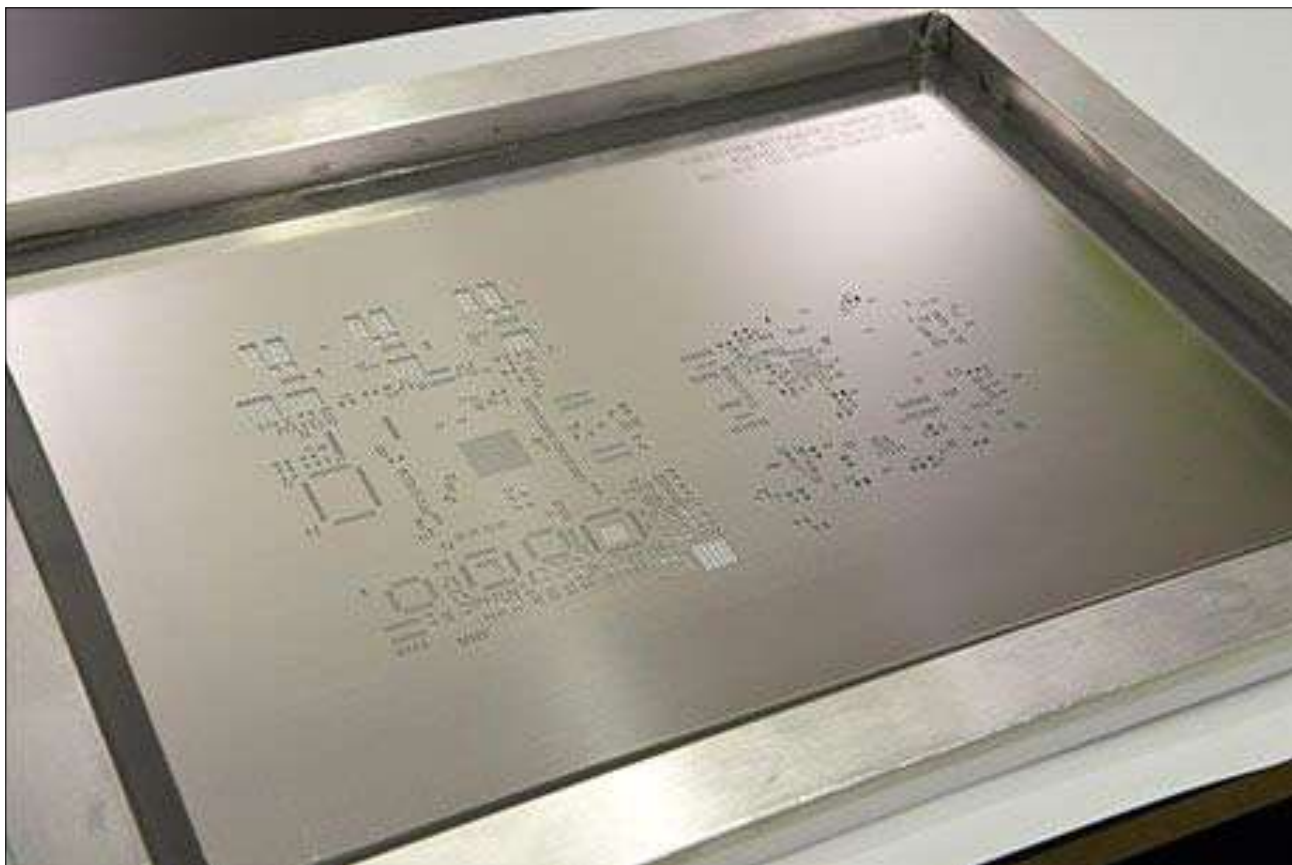
Figura 2: un esempio di stencil per montaggio SMD
