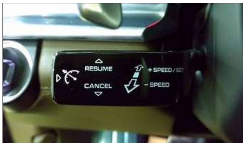
Figura 2. Selettore dell'Adaptive Cruise Control sotto il volante dell'auto
