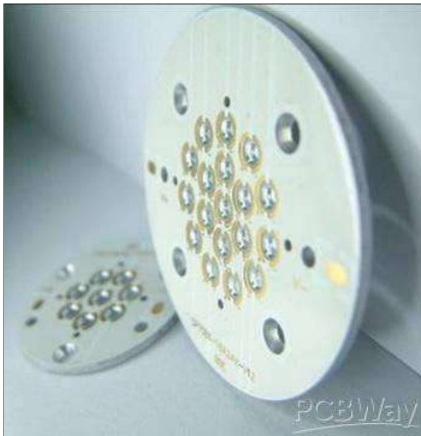
Figura 1: PCB in alluminio ad elevata dissipazione termica
